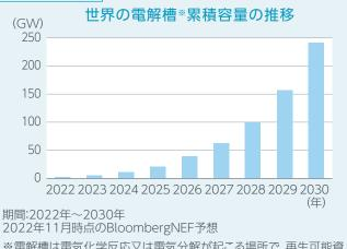
※電解槽は電気化学反応又は電気分解が起こる場所で、再生可能資源からの電気エネルギーを使って水を水素と酸素に分解することで、グリーン水素開発に重要な役割を果たす。
